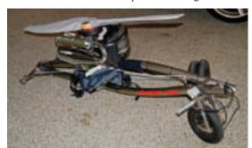
und gänzlich aus Titan gefertigtem Fahrgestell, läßt die Herzen der Leichtluftsportler höher schlagen. Auch der wie ein Minimum zu startende Skyhopper ist revolutionär. Sein neu entwickelter Jetantrieb Skyjet 3000 liefert satte 45 kp Schub. www.aerotechnics.eu B4-404
