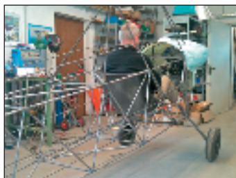
Rebell im Rohbau - Probesitzen: Kostengünstig durch die Übernahme vorhandener Module wie Leitwerk und Flächenkonstruktion: Der „Rebell“ soll flugfertig nur 26.000 Euro kosten.
