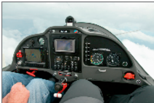
Der rote Hebel unter dem Gas: Er dient zum Verstellen des Varia-Propellers auf Segelstellung.
